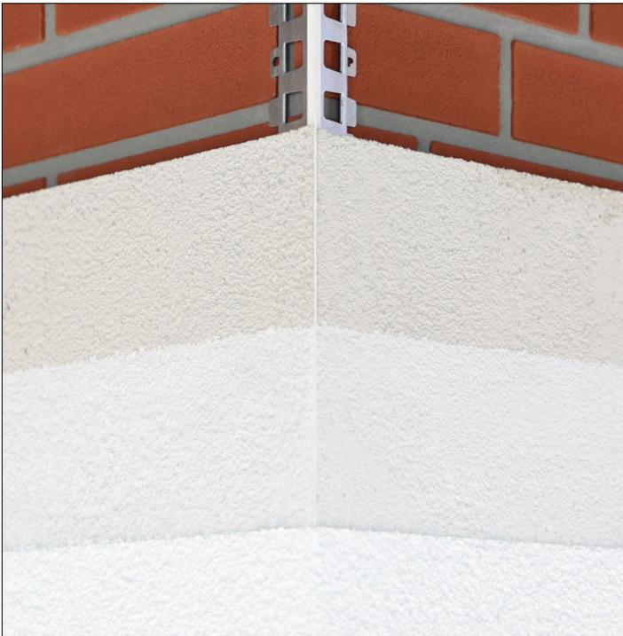
Neben der einfachen Verarbeitung und der Stabilität beim Verputzen sorgt der schmale PVC-Profilkopf für einen verbesserten Korrosionsschutz. Das Ergebnis überzeugt und schützt unsichtbar vor Einflüssen von außen. Die schmale PVC-Kante kann bei zweilagigen Putzsystemen mit Oberputz überarbeitet werden. Besonders gut geeignet für pastöse Oberputze mit erhöhtem Dispersionsanteil.
